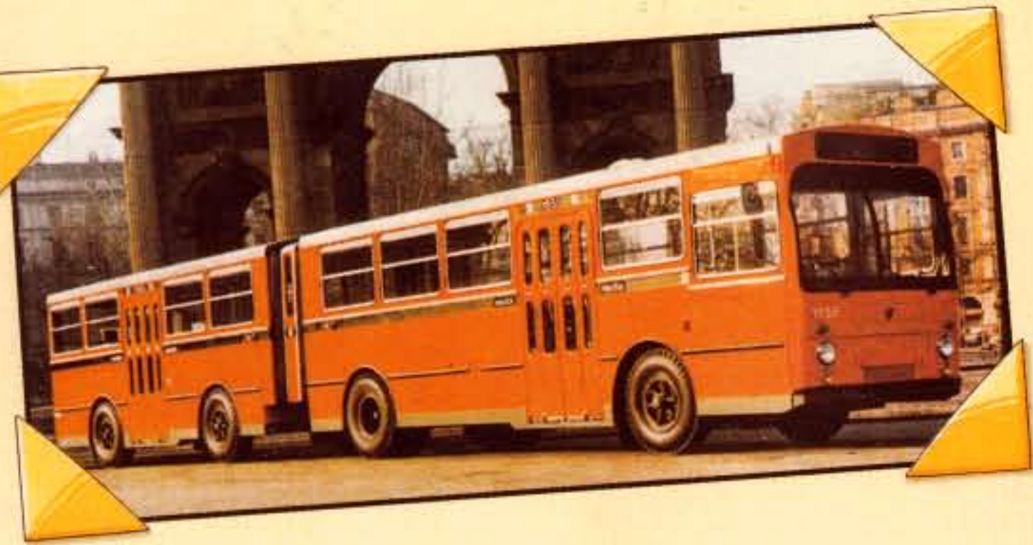
Sopra, un 4 assi Lancia "Esatau 703" ritratto nel 1973 a Milano davanti all'Arco della Pace. Segna l'inizio di una proficua collaborazione della Mauri con l'Alusuisse per la realizzazione di carrozzerie con grandi estrusi in lega leggera. La cassa pesava circa 1200 kg in meno dell'equivalente in acciaio. A destra, un urbano su telaio Fiat "670" esposto al Salone di Torino del 1976.
