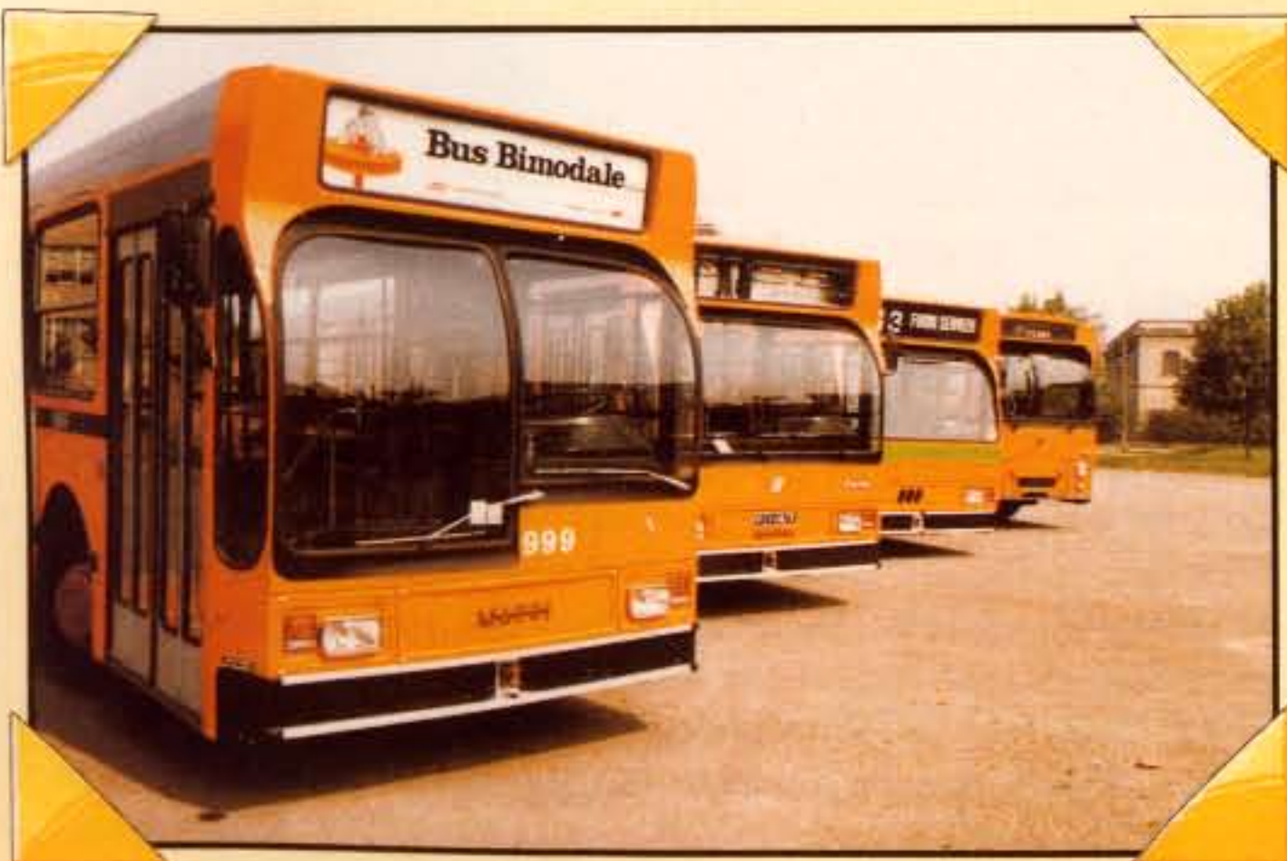
Sotto, parata di autosnodati Mauri; la foto è stata scattata nel 1984. Da sinistra a destra si riconoscono i frontali del bimodale "Bi-Bus", del 3 assi su meccanica del Fiat "470" tipo "pull", ossia con trazione sul secondo asse, e quindi della versione "push" caratterizzata dalla trazione sul terzo asse. Il muso che si intravede sullo sfondo è quello di un Lancia "703".
