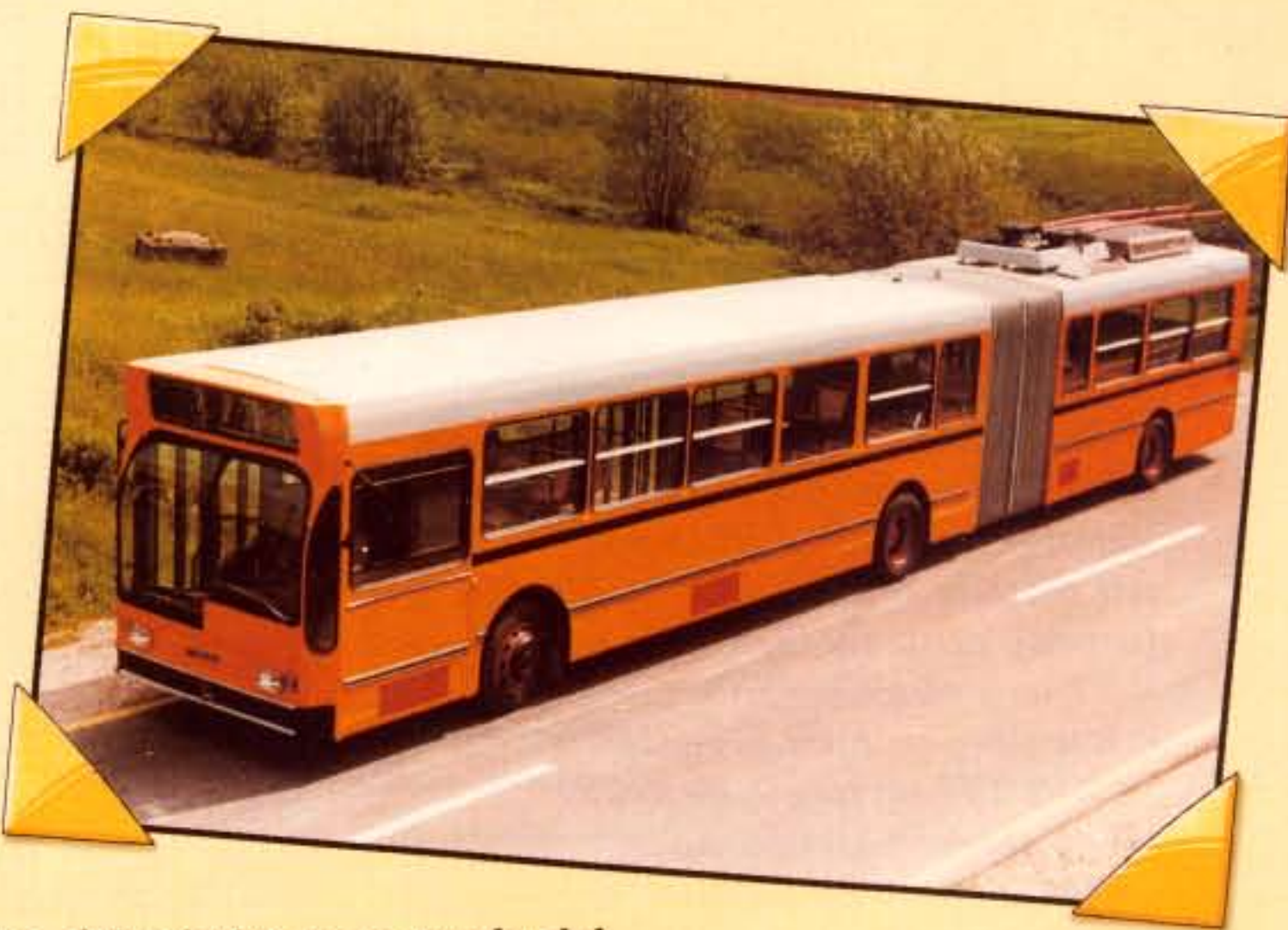
Uno dei primi test su strada del bimodale "Bi-Bus" effettuato nel maggio 1981 lungo il viale dell'aeroporto milanese di Linate (sopra). L'ardito progetto, oltre a conciliare i vantaggi della trazione diesel (sui percorsi veloci extraurbani) con quelli della marcia elettrica silenziosa e pulita (apprezzata nei centri cittadini) introduce i germi innovativi, ripresi successivamente, della trasmissione idrostatica della potenza (sul secondo e terzo asse) e dell'elettronica di controllo. I collaudi del "Bi-Bus" dureranno dieci anni, nel corso dei quali il prototipo della Mauri percorre circa 35 mila km. Il bimodale (l'unico nel suo genere costruito in Italia) viene consegnato all'Atm milanese nel gennaio del 1992.
