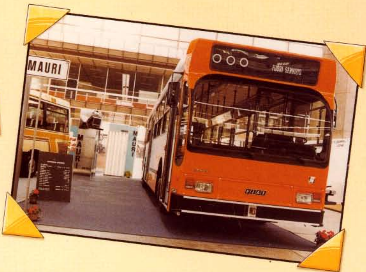
A sinistra, un'immagine del tre assi autosnodato da 18 metri in versione "pull" su autotelaio Fiat "470". L'esordio di questa particolare soluzione cinematica, che comporta la trazione sull'asse centrale e la presenza del terzo asse autosterzante, risale all'inizio del 1981. La carrozzeria, come quasi tutta la produzione della Mauri di quel periodo, è realizzata con estrusi in lega d'alluminio saldati.
